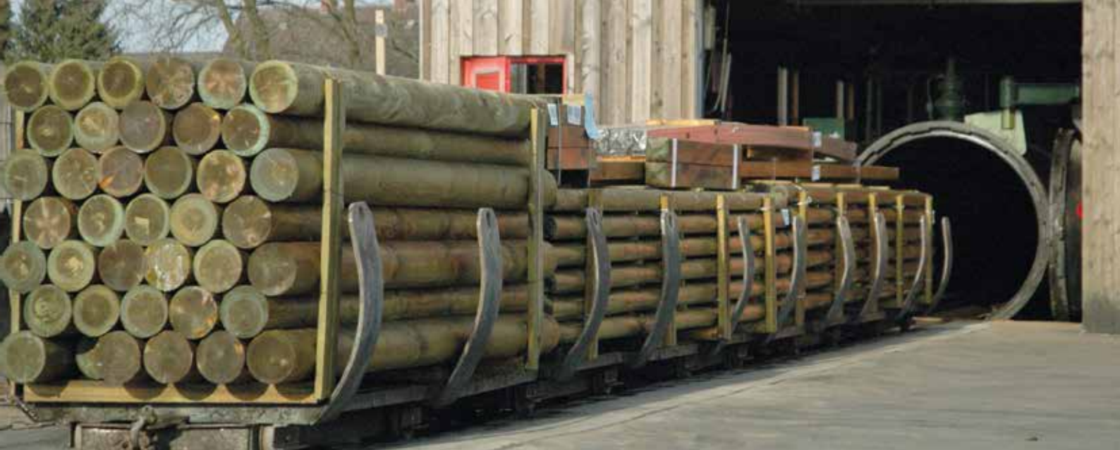
Loren mit Gartenholz – Beladen der Kesseldruckanlage
