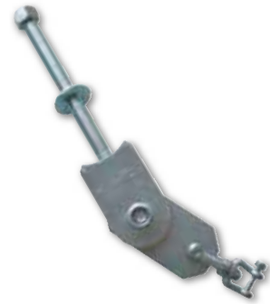
23 Schwinghaken verzinkt, mit Kugellager in einer 10 mm dicken Stahlplatte. Nylonlager (außen Ø 15 mm, innen Ø 6 mm) für die Befestigung von Ketten, Gesamtlänge 160 mm, Gewindestange mit M14-Sicherheitsmutter, Schäkel mitgeliefert.
