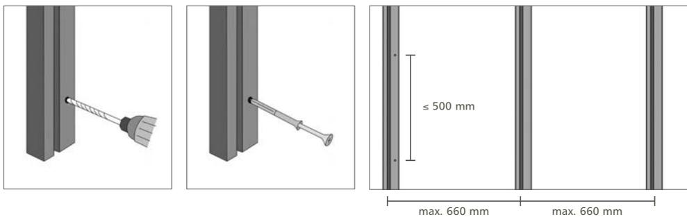
Nutzen Sie ausschließlich die für Pinufix konzipierte Unterkonstruktion R4R 00 N. Für die Befestigung der Unterkonstruktion sollten die Rahmen vorgebohrt werden.
