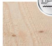
**Feingesägt und gebürstet:** Mit einem präzisen Bandsägeschnitt werden die zu verarbeitenden Holzbalken aufgetrennt, wodurch eine sägeraue Oberfläche entsteht. Durch mehrmaliges aufwändiges Bürsten werden lose Holzfasern entfernt, um höchste Qualität zu gewährleisten. Eine feingesägte und gebürstete Oberfläche bietet den besten Untergrund für jede Farbbeschichtung.
