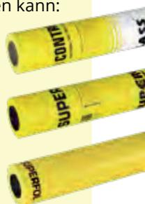
Hinweis: Durch das Rücktrocknungsverhalten von feuchtevariablen Dampfbremsfolien wird die Konstruktion zusätzlich vor Schimmelbildung geschützt. Durch die rückseitige Vlieskaschierung sind sie reißfest, die 10 cm breiten Zuschnitts- und Überlappungsraster erleichtern das Verlegen und Anarbeiten.
