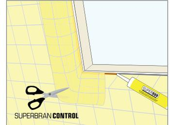
4. Die seitlichen Folienstücke unten und oben einschneiden, damit sie sich faltenfrei in die Laibung legen lassen. „Folienschürze“ umlaufend mit SUPERFORTE DUO- oder SUPERSAN-Klebeband bzw. SUPERDUO-DICHTKLEBER an das Fenster anschließen.
