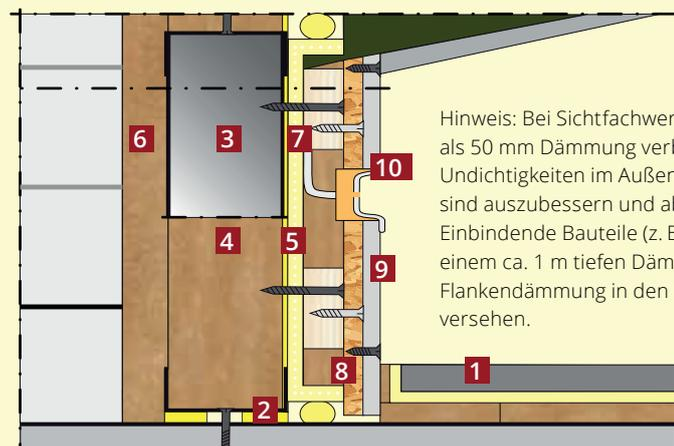
Hinweis: Bei Sichtfachwerk nicht mehr als 50 mm Dämmung verbauen. Undichtigkeiten im Außenmauerwerk sind auszubessern und abzudichten. Einbindende Bauteile (z. B. Wände) mit einem ca. 1 m tiefen Dämmkeil/einer Flankendämmung in den Raum hinein versehen.
